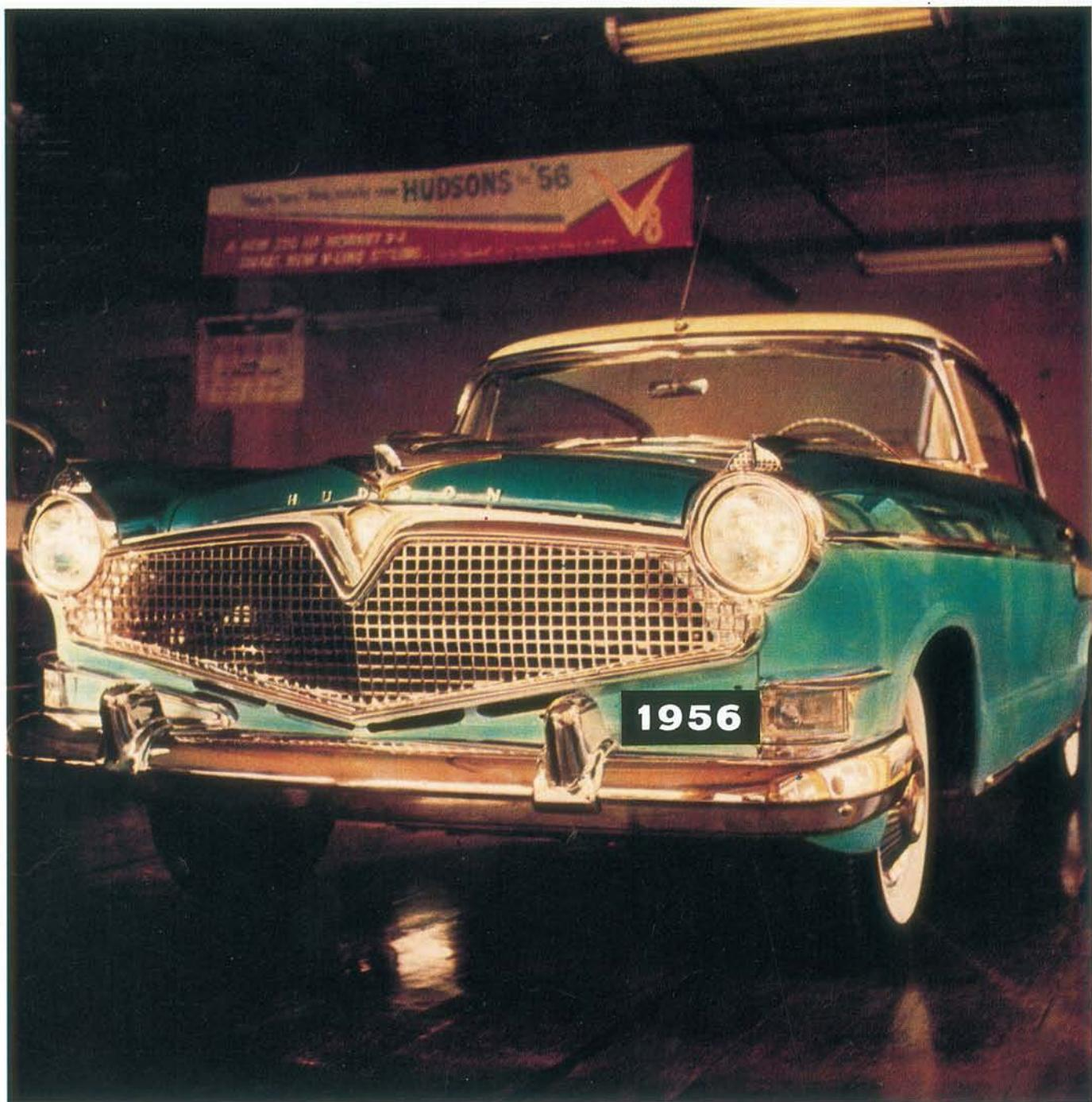
La Hudson «Hornet» con motore ad 8 cilindri a V della potenza di 220 HP.
