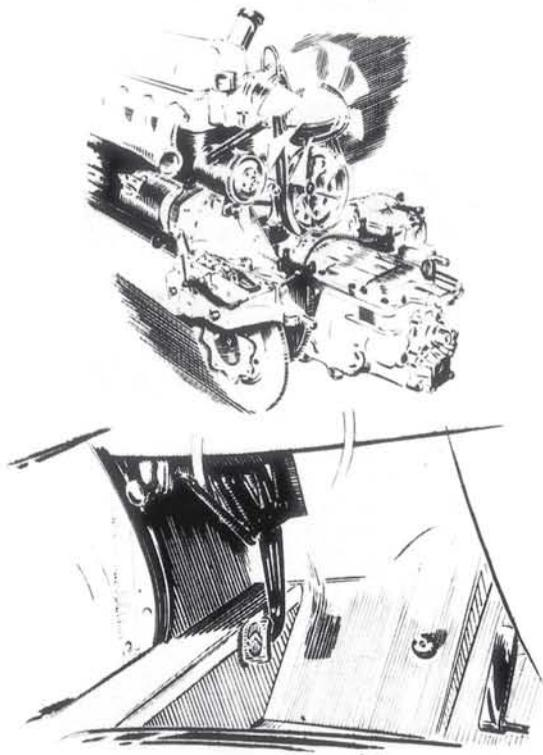
Due particolari costruttivi della Citroën 19 DS. In alto il gruppo motopropulsore dove si notano, oltre al volante a 8 pale in nylon, i freni a disco all'uscita del cambio. In basso la pedaliera, subito a sinistra il freno di parcheggio, in centro il bottone del freno d'esercizio, alla destra il pedalino dell'acceleratore.
