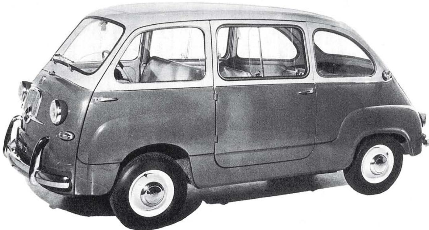
Al vantaggio dei 6 posti la «600 multipla» unisce quello di poter servire, oltre che al trasporto di persone, a quello di cose e merci. Ribaltando i sedili posteriori tutti e 4 o in parte, si ottiene infatti un piano di carico di varia ampiezza, fino a un massimo di mq. 1,75. Il carico massimo utile, oltre l'autista, è di kg. 350.
