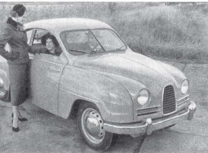
**Un nuovo modello svedese per il 1956, la SAAB 93. Trazione anteriore, tre cilindri, due tempi di 38 CV.**
